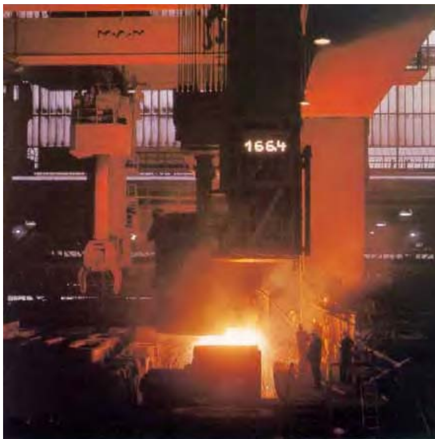
370-тонная весовая траверса взвешивания стального ковша
