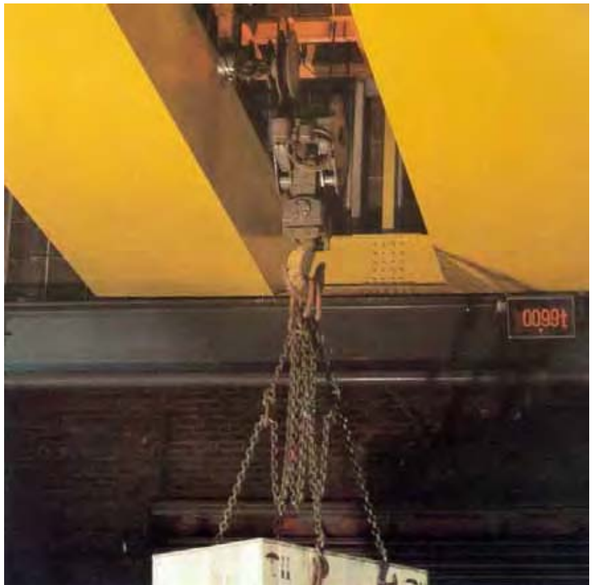
20-тонный весовой блок крюка коммерческих крановых весов на одном датчике веса
